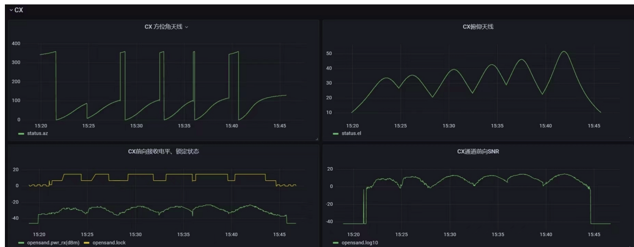
图9 0.45 m“动中通”卫星终端在车速120 km/h下的公路实测结果
