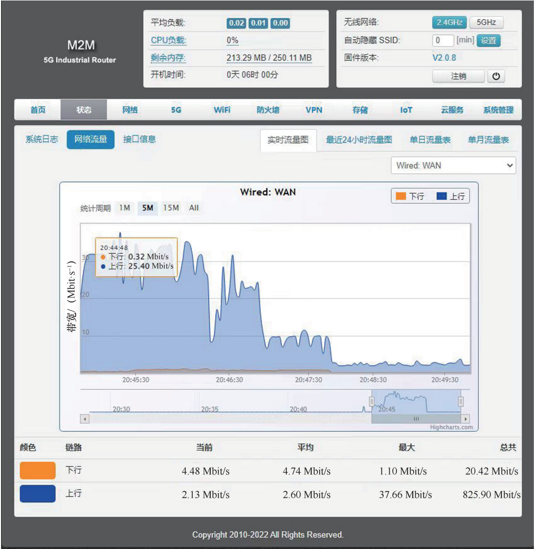
图 7 外场测试卫星终端与信关站模拟主站之间的通信速率测试结果
